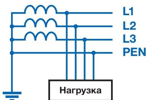
Как следует из буквенного обозначения, для системы TN-C характерно объединение функционального и защитного нулевых проводников. Классической TN-C-системой является традиционная четырехпроводная схема электроснабжения с тремя фазными и одним нулевым проводом. Основная шина заземления в данном случае — глухозаземленная нейтраль, с которой дополнительными нулевыми проводами соединяются все открытые детали, корпуса и металлические части приборов, способные проводить электрический ток.
