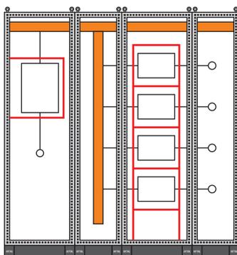
Форма 3a — Разделение сборных шин и функциональных блоков.
