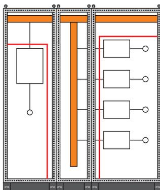
Форма 2b — Разделение сборных шин и функциональных блоков.
