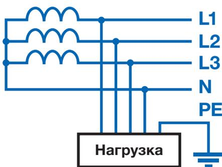
Классическая система, основным признаком которой является изолированная нейтраль источника – I, а также наличие на стороне потребителя контура защитного заземления – Т. Напряжение от источника к потребителю передается по минимально возможному количеству проводов, а все токопроводящие детали корпусов оборудования потребителя должны быть надежно подключены к заземлителю. Нулевой функциональный проводник N на участке «источник — потребитель» в архитектуре системы IT отсутствует.
