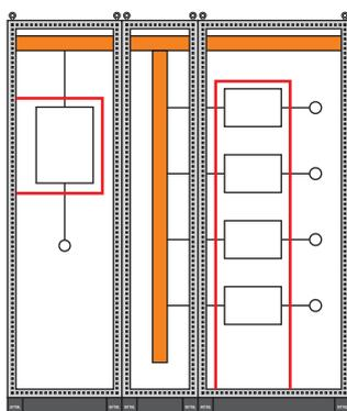
Форма 2a — Разделение сборных шин и функциональных блоков.
