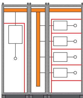
Форма 4a — Разделение сборных шин и функциональных блоков. Отделение всех функциональных блоков один от другого. Разделение зажимов для внешних проводников, связанных с одним функциональным блоком, и зажимов другого функционального блока и сборных шин. Зажимы для внешних проводников в одной секции с функциональным блоком.
