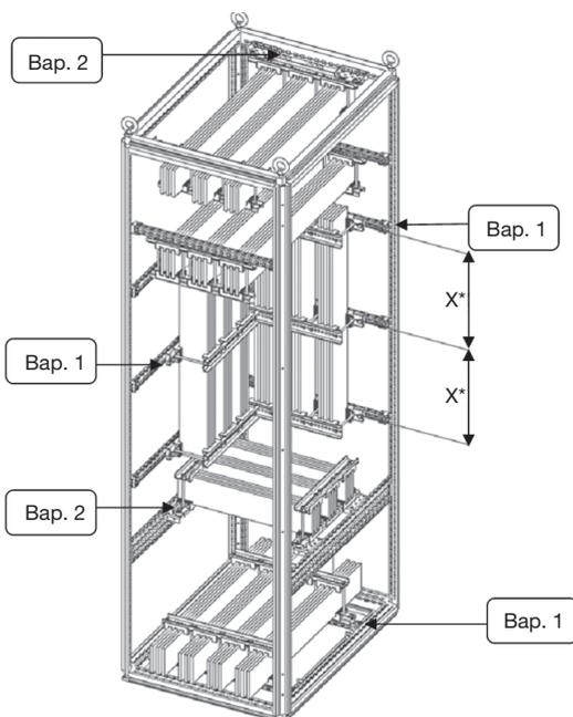
Шинные держатели Rilng используются Rittal с 2010 г. Успешно себя зарекомендовали, как недорогое, простое и надежное изделие. Возможность гибкой регулировки и использования обычной плоской шины (от 30×10 мм до 120×10 мм) существенно расширяют область применения.
