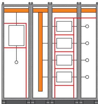
Форма 3b — Разделение сборных шин и функциональных блоков. Отделение всех функциональных блоков один от другого. Разделение зажимов для внешних проводников и функциональных блоков без отделения от зажимов других функциональных блоков. Зажимы для внешних проводников отгорожены от сборных шин.
