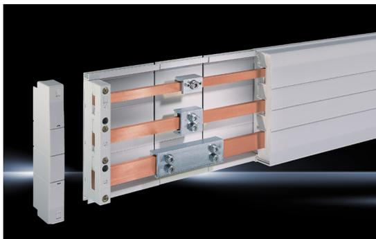
Rittal RiLine60 обеспечивает удобство и быстроту монтажа, индивидуальность и модульность. Это шинная система с расстоянием между шинами 60 мм. Возможно применение как плоских, так и шин специальной формы (PLS). Конструкция держателей шин позволяет монтаж компонентов поверх шин, например, адаптеров подключения, приборных адаптеров и др.
