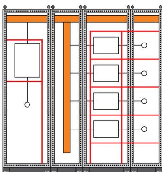
Форма 4b — Разделение сборных шин и функциональных блоков. Отделение всех функциональных блоков один от другого. Разделение зажимов для внешних проводников, связанных с одним функциональным блоком, и зажимов другого функционального блока и сборных шин. Зажимы для внешних проводников в разных секциях с функциональным блоком.
